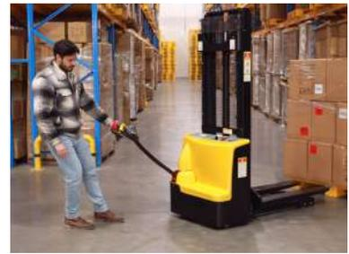
Cuando el camión esté abajo, suelte el freno para mover la unidad manualmente.
