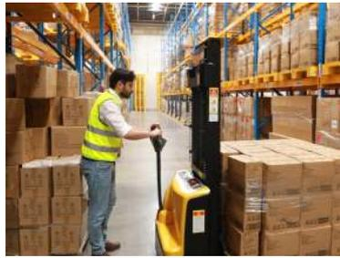
Se maniobra fácilmente con el mango en posición vertical presionando el botón de velocidad de tortuga.
